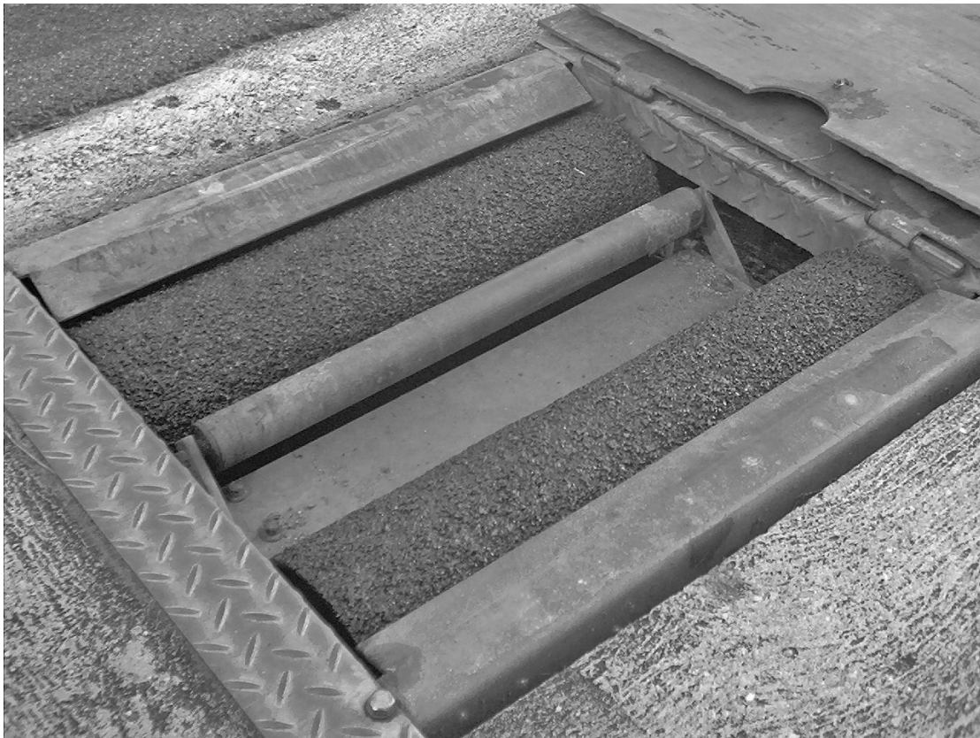
Bremsen-Prüfstand mit KERALIEN - Beschichtung. Brake test bench with KERALIEN - coating.
